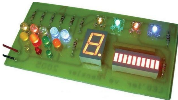
Resim 1-2: Deliklere montaj teknolojisi (Through Hole Technology – THT)
