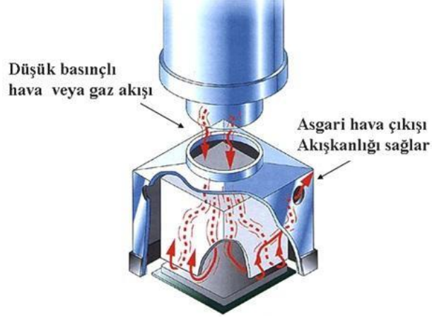
Resim 3-6: Sıcak hava uygulaması
