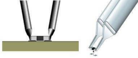
Resim 1-24: Cımbız havya ile SMD eleman sökme
