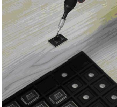
Resim 3-5: Çipsetin vakumlu havya ile taşınması
