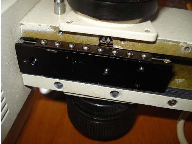
Resim 4.12: Dişli ray, preparat tutucu düzlem ve bilyelerin yerleşimi
