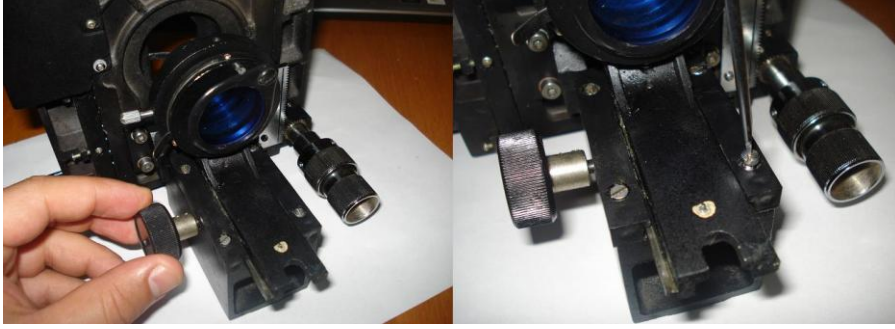
Resim 4.15: Diyafram hareket sistemi ve dikey yatakların sökülmesi
