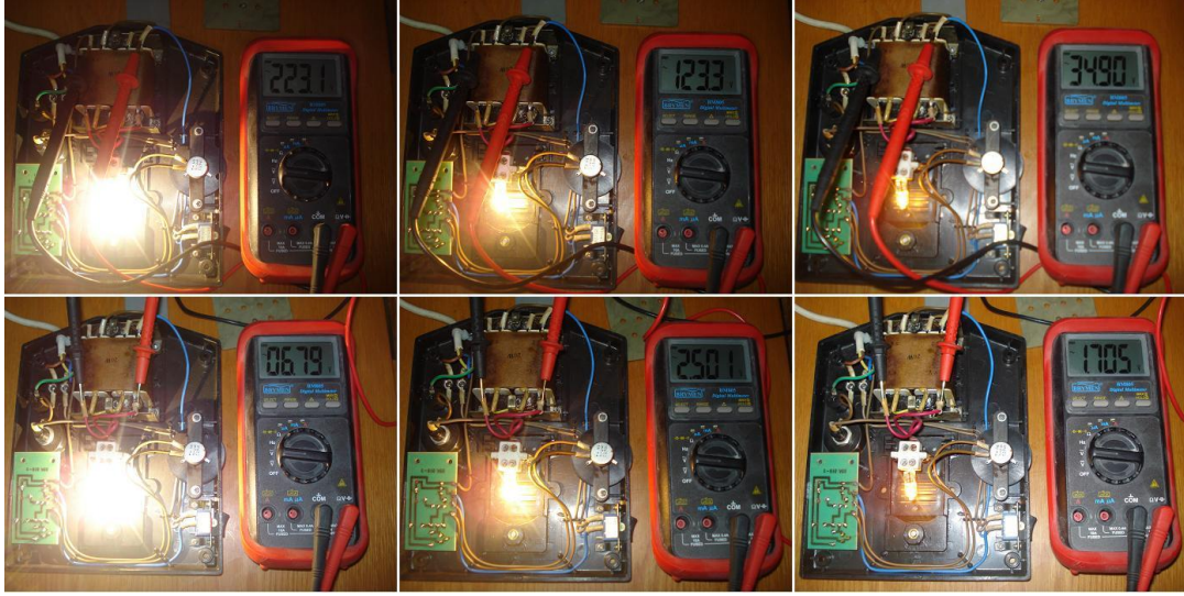
Resim 2.6: AC gerilim deęişimleri ve lamba ışık gücü kontrolü
