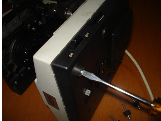
Resim 2.1: Alt kaide ve ışık kaynağı besleme ünitesi demontajı
