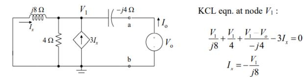
KCL eqn. at node  $V_1$ :
