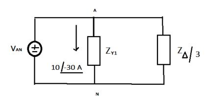
$$V_{AN} = \frac{S_Y}{3 \ I_{AN}^*} = \frac{9000 \ / 53.13^o}{30 \ / 30^o} = 300 \ / 23.13^o \ Vrms$$
