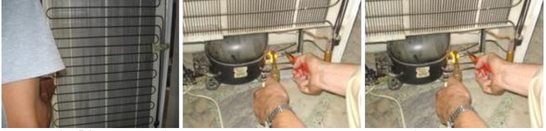
Resim 5.2: Kondanserin kompresör ve drayerdan kaynak yardımı ile ayrıştırılması
