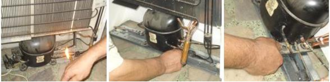
Resim 6.6: Kompresörün kondanser boru bağlantılarının kaynakla ayrılması ve vidaların sökülmesi
