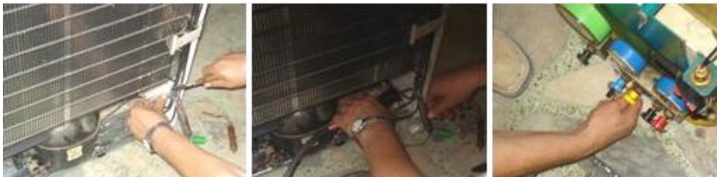
Resim 2.3: Drayer vakum ucu bağlantısı ve vakum pompası düğmesinin açılması
