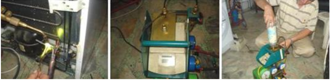
Resim 2.9: Vakum şarj cihazına gaz tüpünün bağlanması
