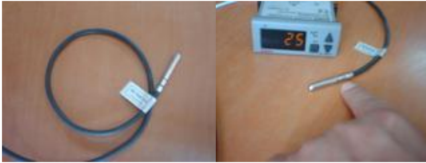
Resim 7.2: Isı algılayıcı ve karta bağlantısı
