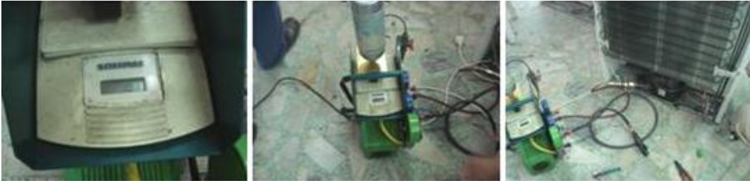
Resim 2.12: Vakum şarj cihazı ile sisteme gaz basılması
