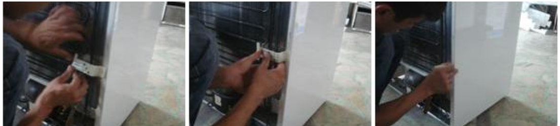
Resim 5.6: Yeni kondanserin dolaba bağlantı vidaları ile bağlanması
