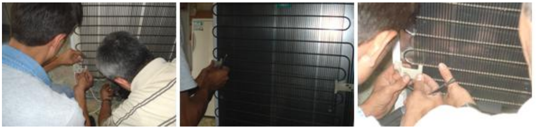
Resim 5.5: Yeni kondanserin dolaba bağlantı vidaları ile bağlanması
