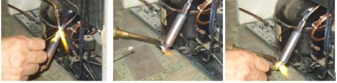
Resim 5.10: Drayerin kılcal boruya kaynak yapılması
