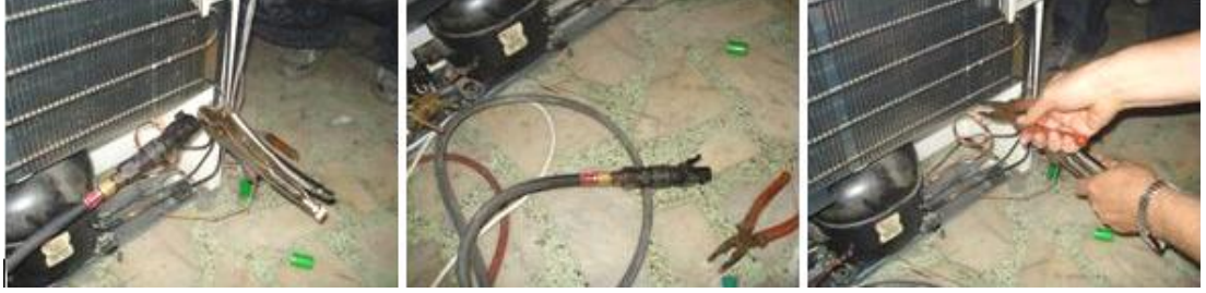
Resim 2.7: Drayer ucunun pincoff ile körlenip vakum hortum ucunun çıkartılması
