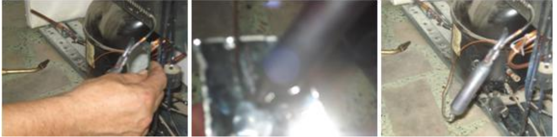
Resim 5.11: Drayerin iki ucunda kaynak yapıldıktan sonra ayna yardımı ile görünmeyen taraflarındaki kaynak kontrolü
