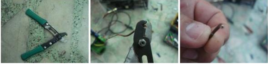
Resim 4.5: Kılcal boru kesme makası ile kılcal boru kesme işlemi
