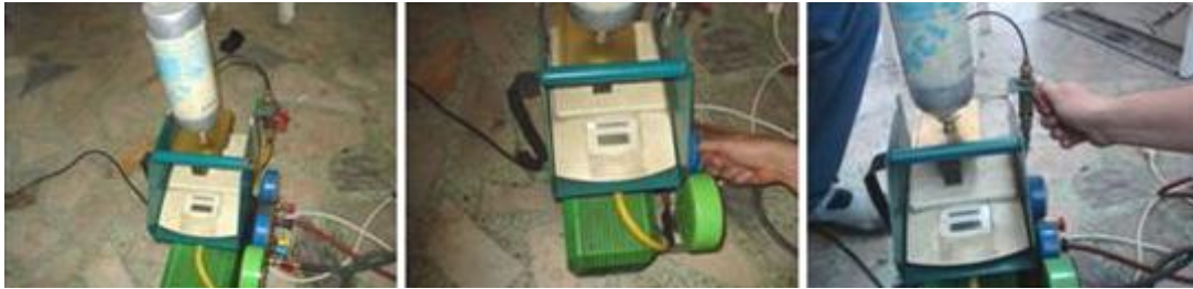
Resim 2.10: Vakum şarj cihazındaki elektronik terazi ile gaz miktarının ayarlanması
