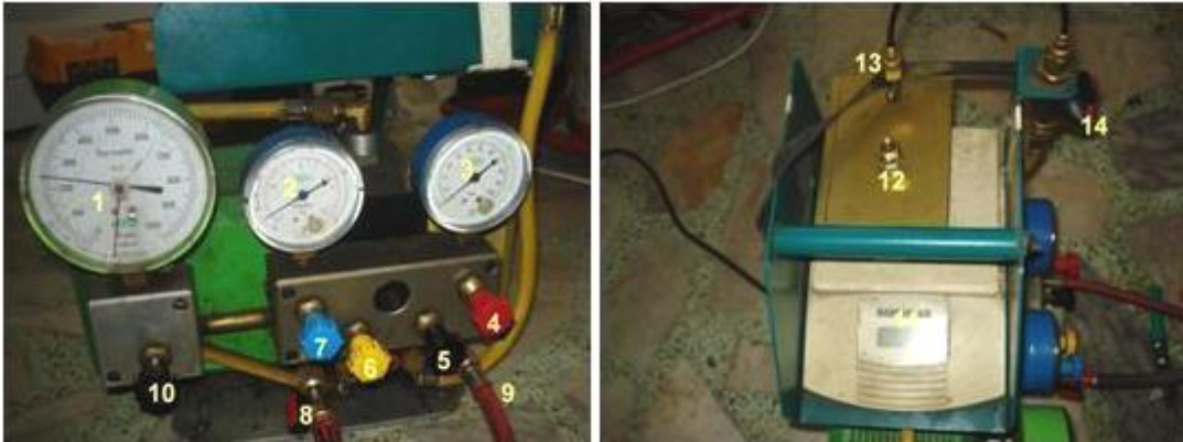
Resim 2.1: Gaz ve vakum şarj cihazı (ön görünüş ve üst görünüş)
