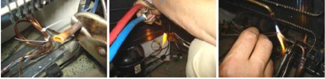
Resim 2.8: Drayer vakum ucunun oksijen ile kaynatılması
