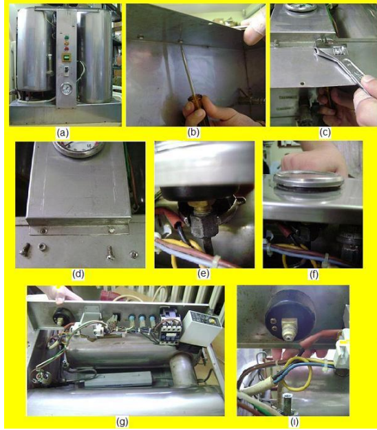
Resim 3.5: (a) Ön panel, (b)(c)(d) ön panelin sökülmesi, (e)(f) manometre bağlantısının sökülmesi, (g) panelin arka görüntüsü (i) manometrenin arka görüntüsü
