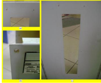
Resim 5.2:(a) Ön panel vida yeri (b) Kapak vida deliği (c) Ön panel boşluğu
