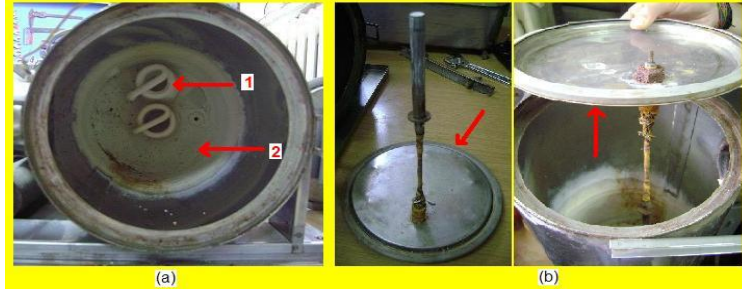
Resim 5.4 Kaynama kazanı iç görünümü (a) 1- rezistans 2-kireç tabakası (b) kapak yerleşimi ve contası
