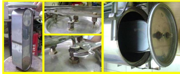
Resim 5.8: Yoğuşturma ünitesi ve kazanı
