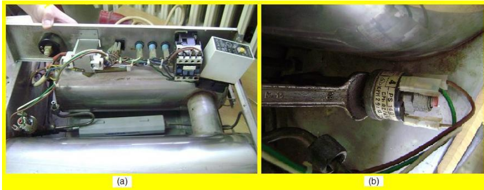
Resim 3.6: (a) Ön panelin sökülmesi (b) basınç algılayıcının sökülmesi
